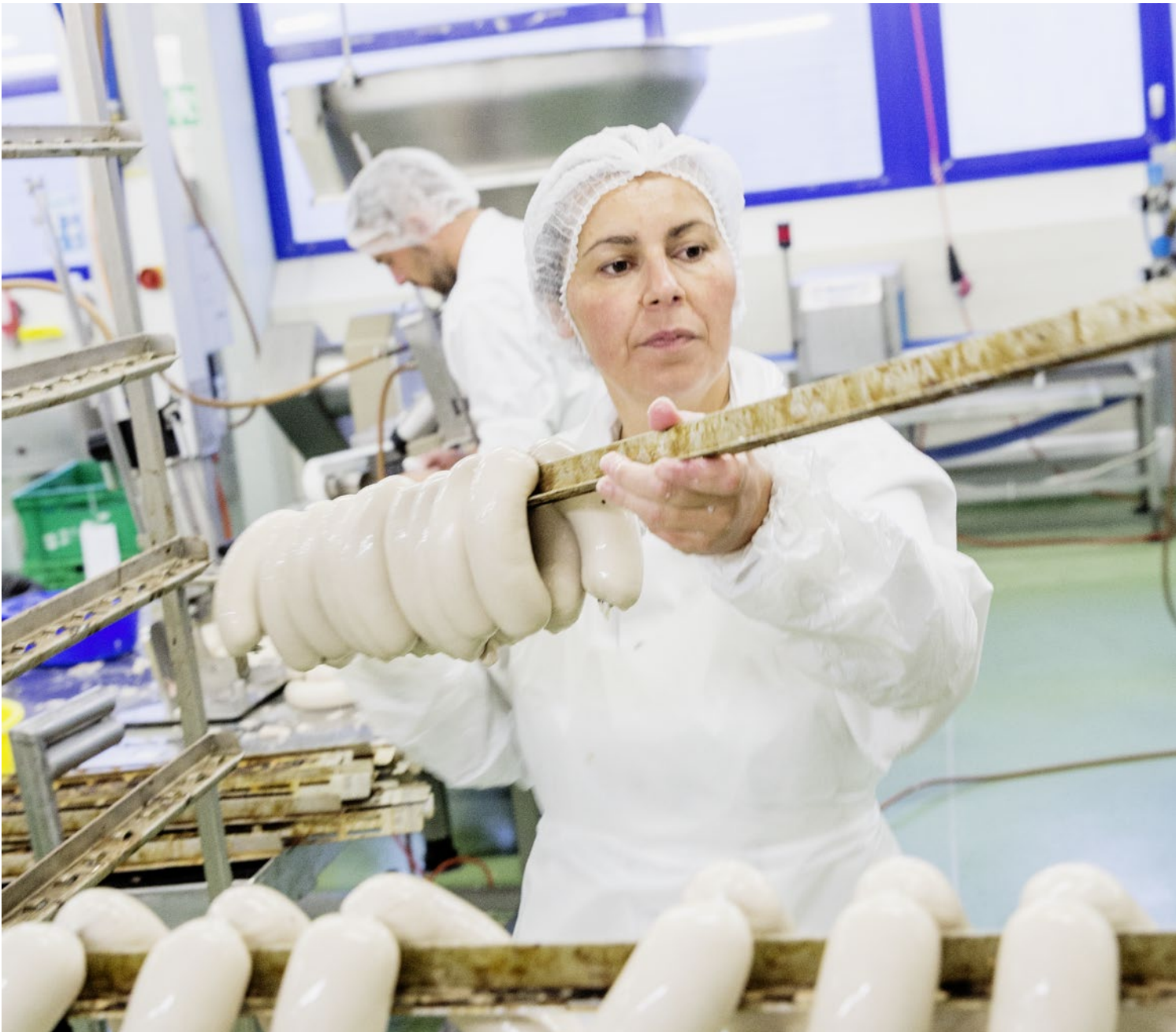
In der Wurst-Maschine wird Kalbsbrät verwurstet, danach werden die Würste zum Trocknen aufgehängt.
